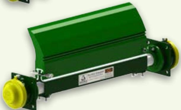
El **SUPER ERASER™** es un limpiador de uso en minas. Tiene un bastidor principal de acero en forma de caja de 0.25" de espesor, de 3.5" x 3.5" y una gran cuchilla Raptor de 12". Puede manejar cualquier cosa que usted le arroje. Si trabaja con correas de alto tonelaje y alta velocidad, el Super Eraser fue construido específicamente para usted. Disponible sólo con Safe Torque.
