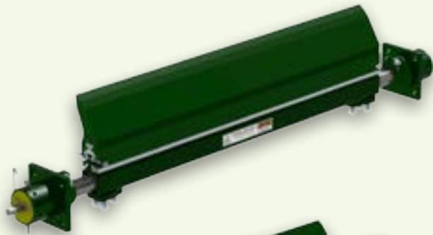
El **MICRO ERASER™** es su respuesta para equipos portátiles con problemas de espacio. Diseñado con nuestra cuchilla Raptor de 6" de altura, funciona mejor en bandas de hasta 48" de ancho con poleas de 28" de diámetro o menos. Este sistema económico pero potente es comparable con el sistema estándar de la competencia. Disponible solamente en estilo pasador.
