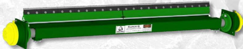
Le Super-G XL avec tungstène est une version plus longue de le Super-G avec tungstène. Il est disponible en longueurs de 72, 84, et 96 po. Le Super-G XL possède un châssis principal creux de 0.25 po d'épaisseur et de 3.5 x 3.5 po. Les goujons au milieu détiennent deux de nos lame de polyuréthane à pointe en tungstène, qui fléchissent pour maintenir la pression contre la courroie.
