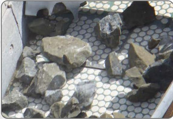
Nos panneaux Redi-Liner de 12 x 12 po peuvent être disposés selon le modèle d'usure dont vous avez besoin. Sa méthode d'installation unique et simple vous permet de ne remplacer que ce qui est nécessaire au lieu de remplacer toute la bande de garnissage.
