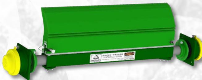
Le Super Eraser est un nettoyeur destiné à la mine. Il possède un châssis principal creux de 0.25 po d'épaisseur et de 3.5 x 3.5 po ainsi qu'une lame massive en polyuréthane de 12 po. Il peut traiter tout ce qui passe. Si vous utilisez des courroies haute vitesse à tonnages élevés, le Super Eraser a été construit spécialement pour vous.
