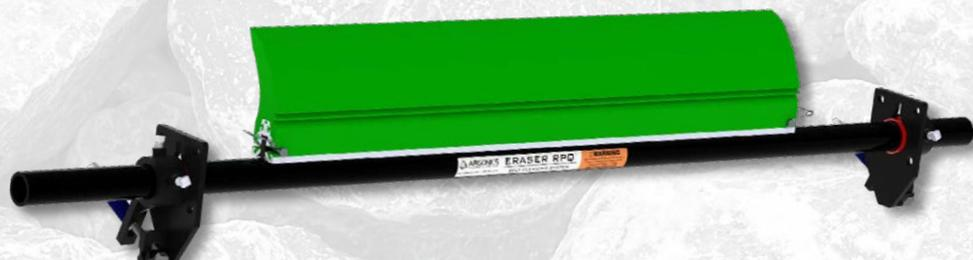
Le système Eraser RPQ utilise le même tensionneur à ressort simple et efficace que celui de l'Eraser PQ et il comporte une lame en polyuréthane de 7 po de hauteur, offrant une durée de vie plus longue et permettant son installation sur des systèmes comportant des poulies de tête d'un diamètre plus élevé.
