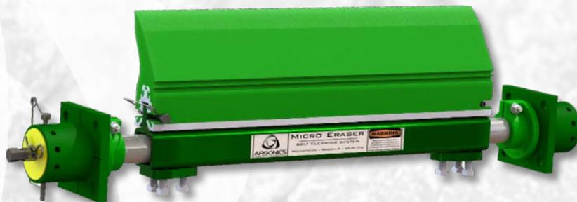
Le Micro Eraser répond à vos problèmes de dégagement serré d'équipement portatif. Conçu à l'aide de notre lame de 6 po en polyuréthane, il fonctionne mieux sur des courroies mesurant au plus 48 po de largeur et des poulies de tête de 28 po de diamètre ou moins. Ce système économique et puissant utilise notre tensionneur breveté Perma-Torque™.
