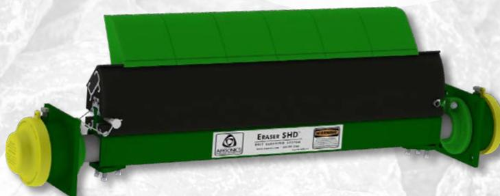
L'Eraser SHD utilise le châssis principal du Super Eraser et des tensionneurs Safe Torque appariés à une lame de 11.25 po de hauteur à bout amovible. Conçu pour la mine, ce système robuste permet de ne remplacer que les sections de bout de la lame de 6 po lorsqu'elles deviennent usées, plutôt que de remplacer toute la longueur de lame.
