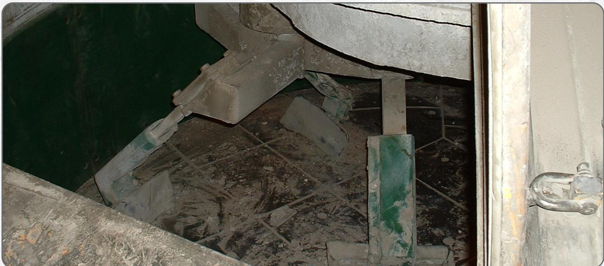
Le système **ERASER** est notre utilitaire industriel standard. Ce nettoyeur robuste et polyvalent est construit autour de notre tensionneur breveté exclusif Perma Torque. Il est muni d'une lame Raptor de 7.25 po de hauteur et peut traiter facilement vos applications les plus exigeantes.
