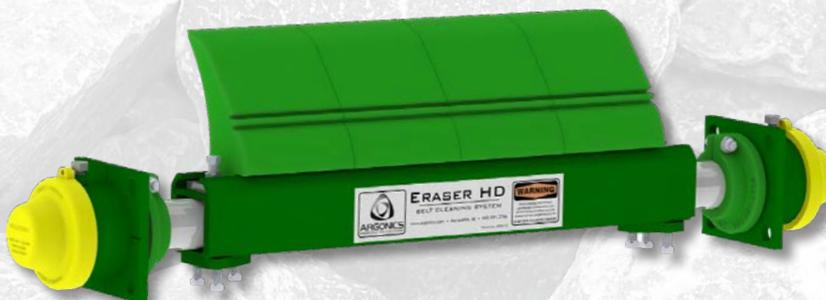
L'Eraser HD est conçu pour résister aux fortes vibrations. Ce système possède un châssis principal renforcé et une conception robuste de fixation à profilé. Il utilise une série de segments de lame en polyuréthane de 6 po de largeur x 7 po de hauteur qui se conforment aux poulies de tête bombées.
