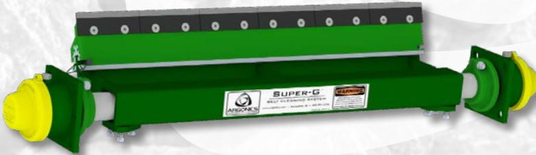
Le Super-G avec tungstène offre une lame unique complètement modifiée. Il utilise le même châssis principal et le même tensionneur Perma-Torque que le Super-G avec uréthane. La cartouche en uréthane retient des embouts de lame en tungstène de 6 po, ce qui permet aux lames de courber et maintient le contact et la pression contre la courroie.
