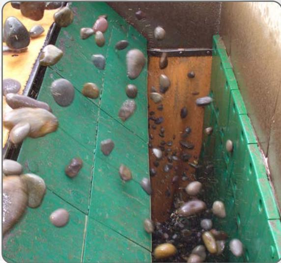
Les plaques d'usure aident à éliminer l'adhérence du matériau et diminuent grandement les niveaux de bruit. Nos plaques d'usure en polyuréthane se sont avérées plus rentables que les bandes de garnissage en acier dans un rapport de 5 pour 1.
