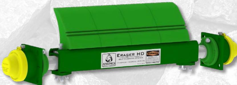
L'Eraser HD è progettato per resistere a forti vibrazioni. Il sistema dispone di un telaio principale rinforzato e di un collegamento a canale progettato per offrire un'elevata resistenza. Il raschiatoio utilizza una serie di segmenti in poliuretano di 15 cm (6") di larghezza x 18 cm (7") di altezza che si adattano alle pulegge di testa a corona.
