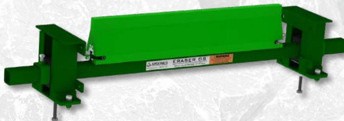
L'Eraser DS è una versione economica del nostro sistema di pulizia XTC, con telaio principale tubolare in acciaio verniciato a polvere di 5 cm x 5 cm (2" x 2") e 5 mm (0,19") di spessore, per assicurare resistenza e durata. Il modello DS utilizza la stessa lama in poliuretano dell'XTC.
