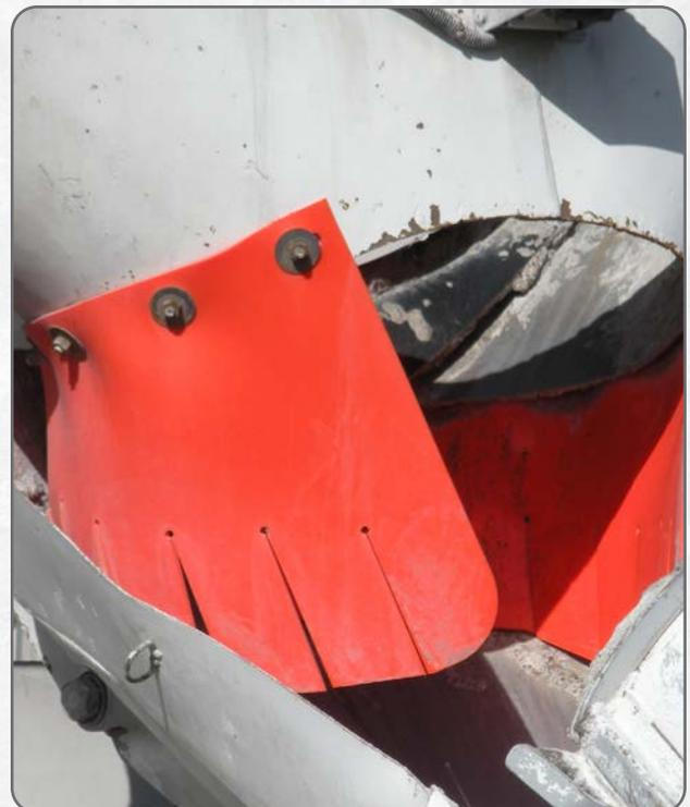
Le spatole e i raschietti per miscelatori Argonics sono progettati per il retrofit delle apparecchiature OEM. Si fissano in modo simile alle lame metalliche, quindi è facile sostituirli. Sono prodotti secondo le stesse formule di poliuretano Kryptane Argonics a cui il settore del calcestruzzo si affida da 20 anni.
