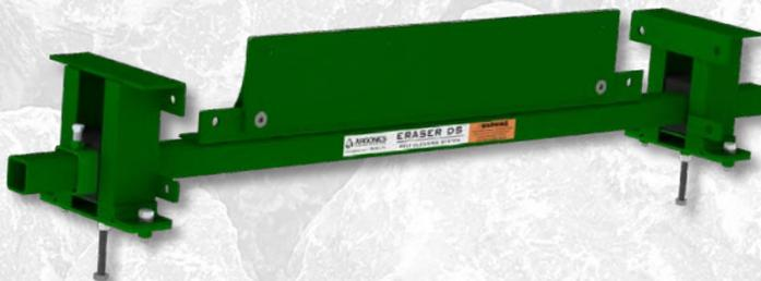
Il sistema Eraser DS al tungsteno è privo di uretano e destinato all'utilizzo con materiali ad alte temperature. Impiega lo stesso telaio principale tubolare in acciaio verniciato a polvere di 5 cm x 5 cm (2" x 2") e 5 mm (0,19") di spessore del sistema DS. Inoltre, presenta le stesse lame al carburo di tungsteno dell'XTC.
