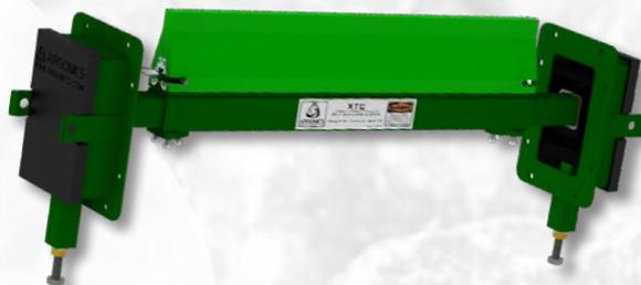
L'XTC è un potente sistema di pulizia per nastri trasportatori a inversione di direzione. Il sistema può gestire condizioni di bagnato e secco, e materiali viscosi o appiccicosi. L'esclusivo tensionatore Web-Torque offre elasticità sufficiente sulle giunzioni meccaniche e il design a scorrimento del raschiatoio riduce l'accumulo di materiale.
