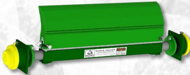
Il Super Eraser è un sistema di pulizia per applicazioni minerarie. Presenta un telaio principale in acciaio di 9 cm x 9 cm (3,5" x 3,5") e spessore di 6 mm (0,25"), e un massiccio raschiatoio in poliuretano da 30 cm (12"). È in grado di gestire qualunque tipo di materiale. Il Super Eraser è stato realizzato appositamente per applicazioni con nastri a elevata velocità e alto tonnellaggio.
