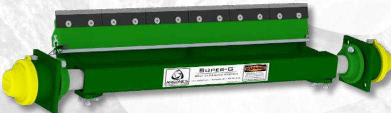
Il Super-G con tungsteno è dotato di una lama ridisegnata e assolutamente unica. Utilizza lo stesso telaio principale e lo stesso tensionatore Perma-Torque del Super-G in uretano. La cartuccia in uretano ospita le punte delle lame al tungsteno di 15 cm (6"), che consentono al raschiatoio di flettersi insieme al tappeto, mantenendo il contatto e la pressione contro di esso.
