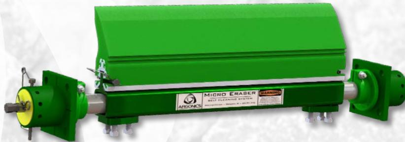
Il Micro Eraser è la risposta ideale per attrezzature trasportabili con problemi di spazi ristretti. Progettato con raschiatoio di 15 cm (6") di altezza, è particolarmente adatto a tappeti fino a 122 cm (48") di larghezza, con pulegge di testa di diametro pari o inferiore a 71 cm (28"). Questo sistema, economico ma potente, utilizza il nostro tensionatore brevettato Perma-Torque™.
