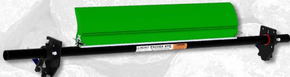
Il sistema Eraser RPQ utilizza la stessa semplice ed efficace unità di tensionamento a molla dell'Eraser PQ, ma con una lama in poliuretano di 18 cm di altezza che garantisce una maggiore resistenza all'usura e consente l'installazione su sistemi con pulegge di testa di diametro maggiore.
