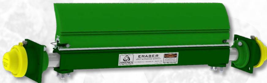
Il sistema Eraser è lo strumento perfetto per applicazioni industriali standard. Questo sistema di pulizia, robusto ma versatile, è costruito attorno al nostro esclusivo sistema di tensionamento Safe Torque brevettato. È equipaggiato con un raschiatoio in poliuretano di 18 cm (7,25") di altezza e può gestire agevolmente gran parte delle applicazioni più impegnative.
