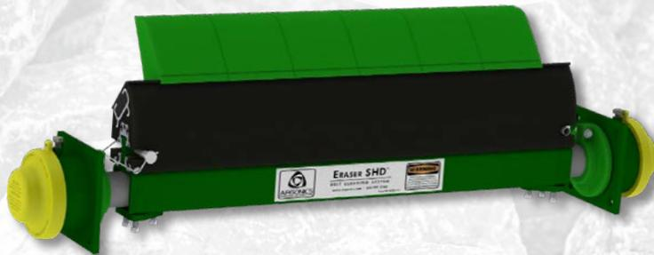
L'Eraser SHD utilizza il telaio principale e i tensionatori Safe Torque di Super Eraser, abbinandoli a una lama di 28 cm (11,25") di altezza con punta sostituibile. La progettazione di questo sistema a elevata resistenza, ideale per applicazioni minerarie, consente di sostituire, quando si consumano, le sole sezioni di punta della lama di 15 cm (6") anziché l'intera lunghezza del raschiatoio.
