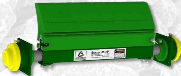
L'Eraser MDP è identico al sistema Super Eraser, ma è dotato di raschiatoio monoblocco in poliuretano da 28 cm (11,25"), con lo stesso profilo della lama dell'SHD. Destinato all'utilizzo nelle applicazioni minerarie più gravose, l'MDP è estremamente robusto, resistente e durevole.
