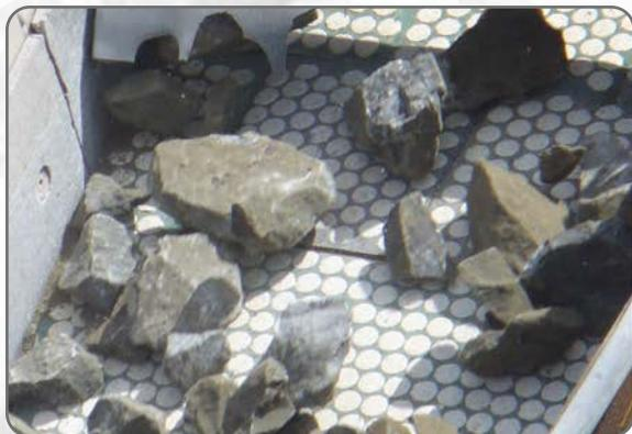
I nostri pannelli Redi-Liner da 30,5 x 30,5 cm (12" x 12") possono essere sistemati in qualsiasi disposizione necessaria a contenere l'usura. L'esclusivo e semplice metodo di installazione permette la sostituzione dei soli pannelli richiesti, anziché dell'intero rivestimento.
