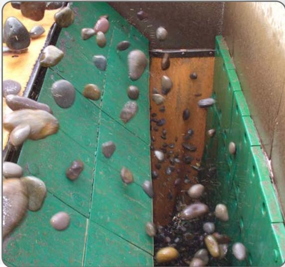
Las placas de desgaste ayudan a eliminar la adhesión de material y atenúan los niveles de ruido significativamente. Nuestras placas de desgaste de poliuretano han demostrado ser rentables en comparación con los recubrimientos de acero en proporción de hasta 5 a 1.
