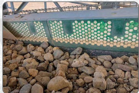
*El faldón lateral de contención viene con tapones de poliuretano Snap-Tite que cubren las ranuras de montaje y evitan la acumulación de material.*
