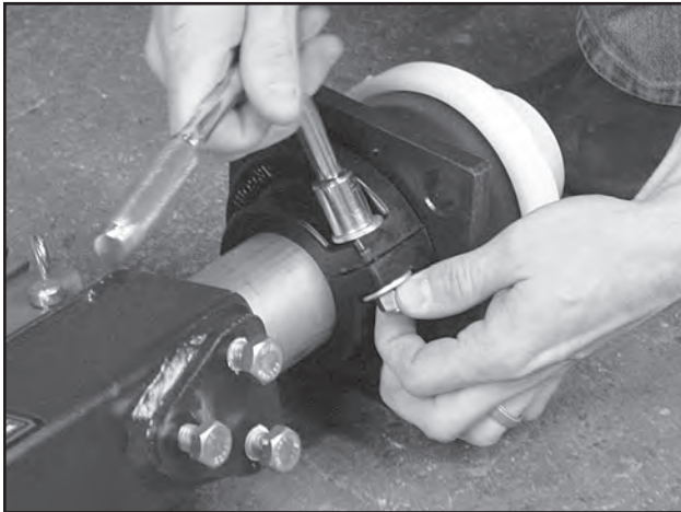
Quite los collarines de retención de uretano de los extremos del eje.
